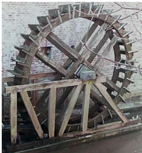
Fig. 32 : Photo d'une roue dite en dessous. ©
