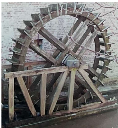
Fig. 32 : Photo d'une roue dite en dessous. © Commune de Schiffange.
